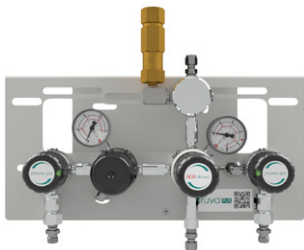
Typ MPLHOMDS0U Option S0 HD Absperrventil (Absperrventil im Eingang | keine Armatur im Ausgang) Zusatz U Rückschlagsventil im Eingang Sicherheitsventil im Ausgang
